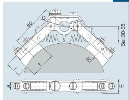
Die Bürstenhalter mit der Endziffer 0 in der Typenbezeichnung sind nur für den Schutzleiter-Schleifring bestimmt und mit dem Schutzleiter gekennzeichnet. Sie weisen eine andere Bohrung auf und ihre Kohlebürsten sind gegen die der anderen Halter nicht vertauschbar.
